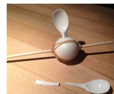
3. Schneide die Stiele der Esslöffel ab, so dass sie noch etwa vier cm lang und stecke sie in gleichmäßigen Abständen rund um die Kugel. Die Innenflächen der Löffel sollten immer in die gleiche Richtung zeigen.
