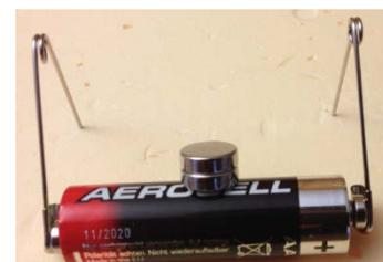
4. Um die Rundbatterie wickelt man einen ca. 80cm langen und 0,5 mm dicken Kupferlackdraht (Kupferlack Draht). Dazu lässt man ca. 10 cm an beiden Enden frei.
